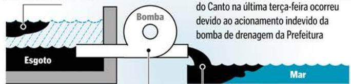
A bomba da Cesan só funciona em dias de estiagem. Quando chove ela para de funcionar e o esgoto que está na rede de drenagem vai para o mar, diluído com a água da chuva
